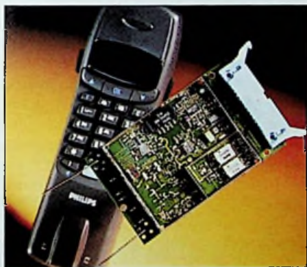
HF-vermogensversterker voor digitale handtelefoons.
